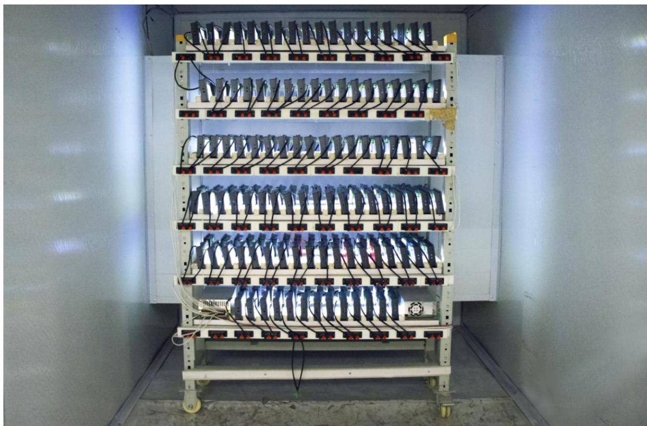
测试环境:高低温老化测试箱中
